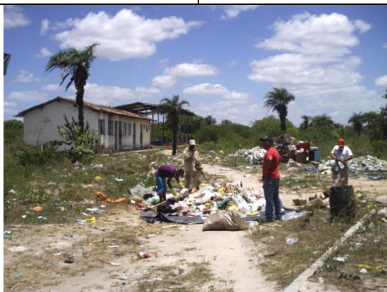
Foto 55: Ensaio de caracterização gravimétrica no município de Santana do Ipanema.
