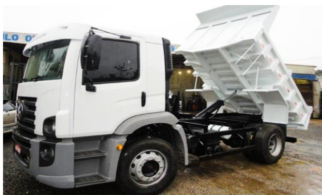
Figura 5.30 e Figura 5.31 – Caminhões caçamba basculante do tipo “Toco” (esquerda) e caminhão trucado (direita).
