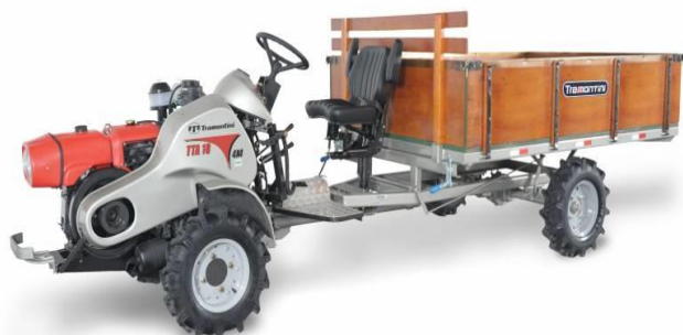
Figura 5.34 e Figura 5.35 – Modelo de microtrator que pode ser utilizado na coleta em locais de difícil acesso (esquerda) e trator com carroceria acoplada utilizado na coleta de resíduos em Jacuípe.
