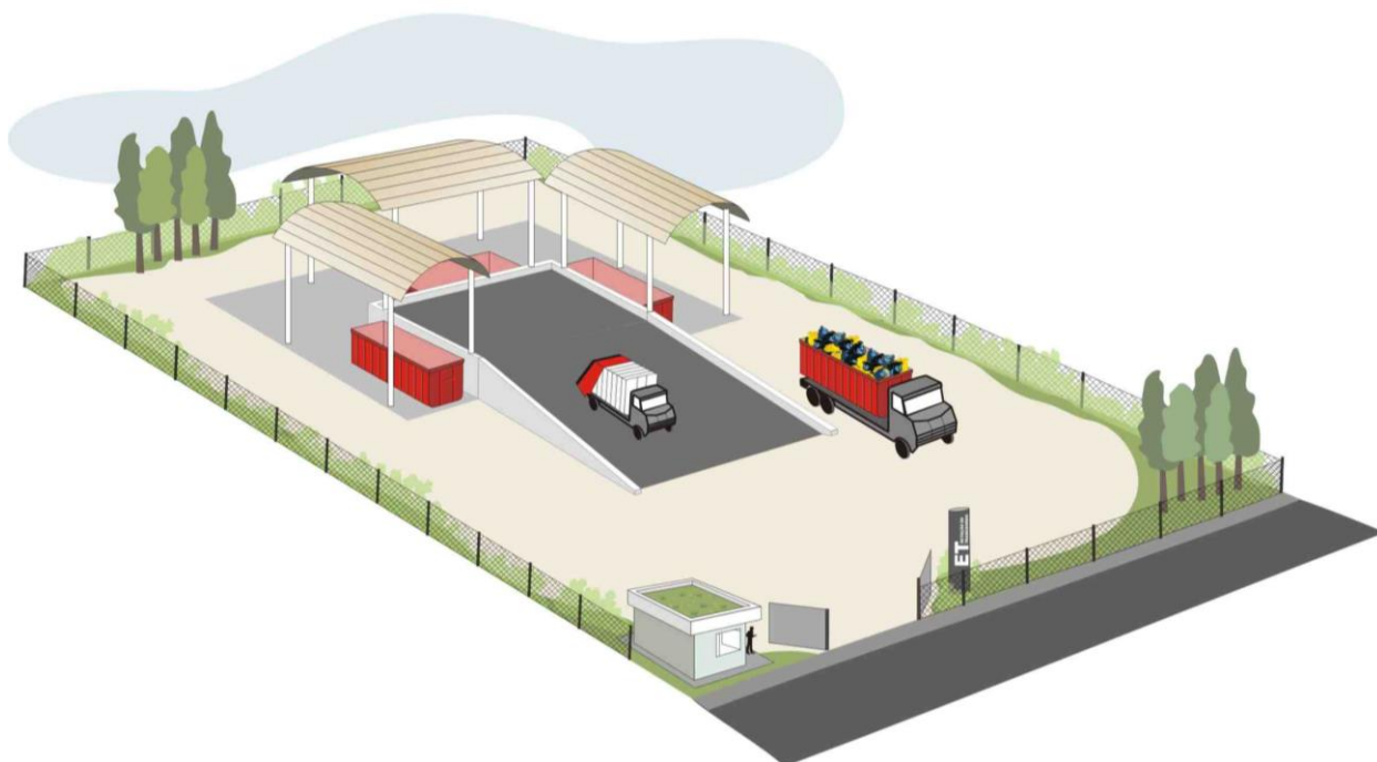
Figura 5.2 – Estação de Transbordo de resíduos sólidos urbanos.
