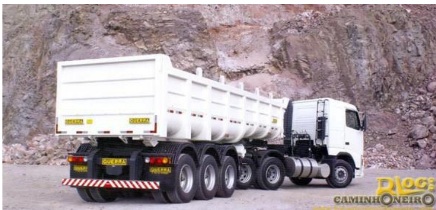
Figura 5.36 – Caminhão caçamba com alta capacidade de carga para transporte de grandes volumes de RCC.
