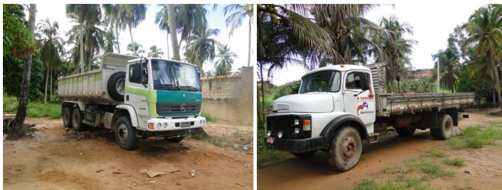
Figura 5.62 e Figura 5.63 – Caminhão basculante e com carroceria utilizados na coleta de resíduos sólidos em Japaratinga.
