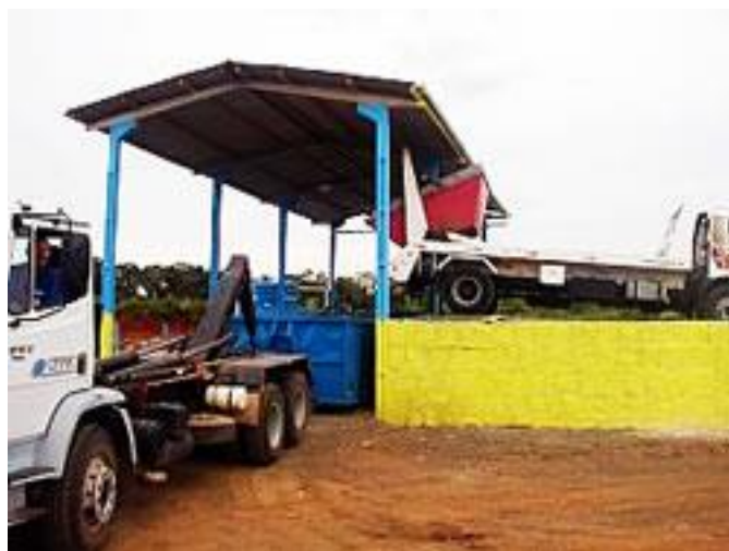
Figura 5.5 e Figura 5.6 – Transferência de resíduos (esquerda) e etapas de carregamento da caçamba roll on roll off (direita)
