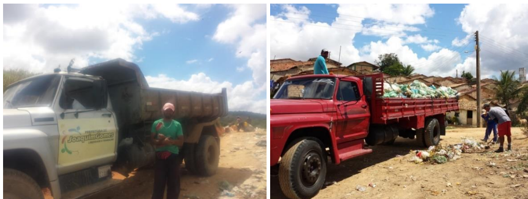
Figura 5.64 e Figura 5.65 – Caminhão basculante e com carroceria utilizados na coleta de resíduos sólidos em Joaquim Gomes.
