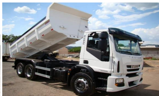
Figura 5.30 e Figura 5.31 – Caminhões caçamba basculante do tipo “Toco” (esquerda) e caminhão trucado (direita).
